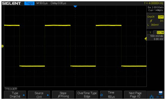
Figure 31: Edge DropOut Trigger
