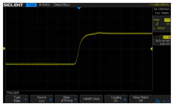
Figure 24: Edge Trigger
