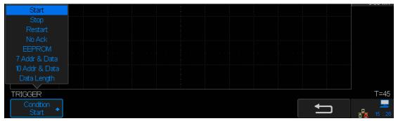
Figure 37: IIC TRIGGER Menu
