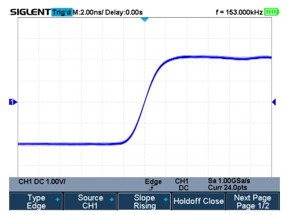
Figure 27 Edge Trigger
