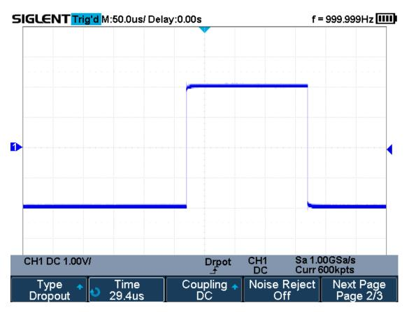
Figure 34 Edge Dropout Trigger
