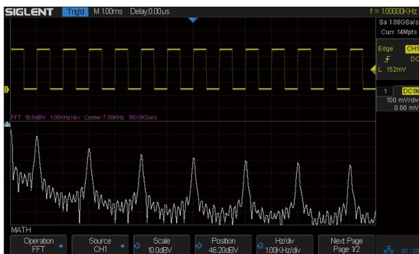
除传统的 (+, -, \*, /) 运算外，SDS1000X 示波器支持 FFT, 微分、积分、平方根运算
