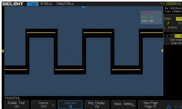
SDS1000X 实现了基于硬件的 Pass/Fail 测试功能，每秒执行高达 60,000 次测试。可根据用户自定义的垂直和水平容限，将被测信号与创建的模板信号进行比较，适用于长期监测信号或进行生产线测试。
