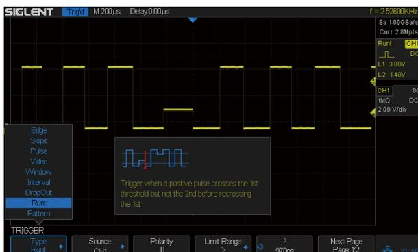
具有丰富的触发功能，包括边沿、斜率、脉宽、视频、窗口、欠幅、间隔、超时、码型、I<sup>2</sup>C、SPI、UART/RS232、LIN、CAN
