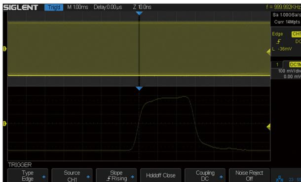
利用基于硬件的 Zoom 技术和高达 14Mpts 的深存储，用户能够使用更高的采样率捕获更长时间的信号，然后快速放大需要关注的区域
