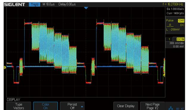
色温显示，以颜色的冷暖程度表示波形的出现概率，色度值越暖，波形出现概率越高
