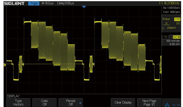
SPO 显示技术是高刷新率和多帧叠加的结果，当单位时间内，当某一像素点出现的波形概率越高，该像素点就越亮，反之越暗
