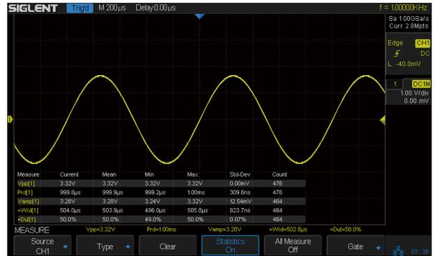
参数统计功能可显示任意参数的五种测量值：当前值、平均值、最小值、最大值、标准差，最大可同时测量统计五种不同的参数。支持 Gating 测量、Math 测量、History 测量和 Ref 测量
