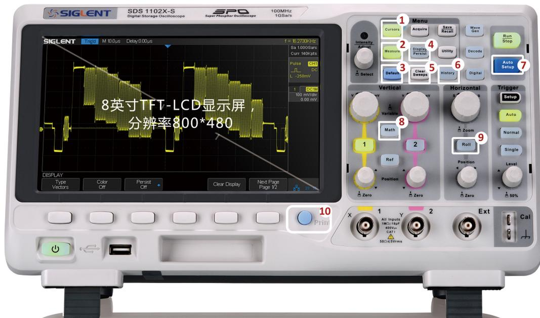
SDS1000X 配备 8 英寸 TFT-LCD 显示屏, 分辨率 800\*480
