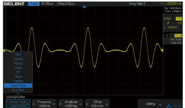
SDS1000X-S 内置了 25MHz 函数 / 任意波形发生器，集成了 10 种常用波形，用户也可通过 EasyWave 上位机软件编辑任意波形
