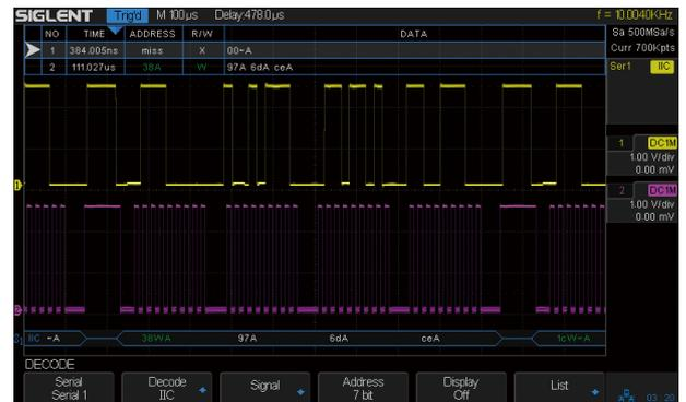
通过事件列表显示解码结果，能快速、直观地将总线的协议信息以表格形式显示。
